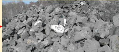
Salzschlacke ist ein Reststoff, der bei der Einschmelzung von Al-Schrotten unter Salz anfällt – In Stockach erfolgt eine vollständige Wiederaufbereitung
